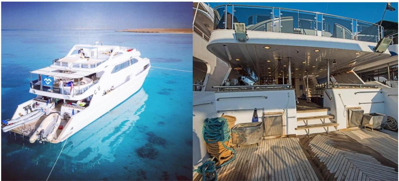
El CU es un yate de 37 metros de eslora y 8,5 metros de manga con cuatro cubiertas. Está equipado con dos motores 750HP Catepillar, 2 generadores de 60w, y dos compresores ColtriSub de 190l/min, además de dos zodiac 2 x 25HP Yamaha.
